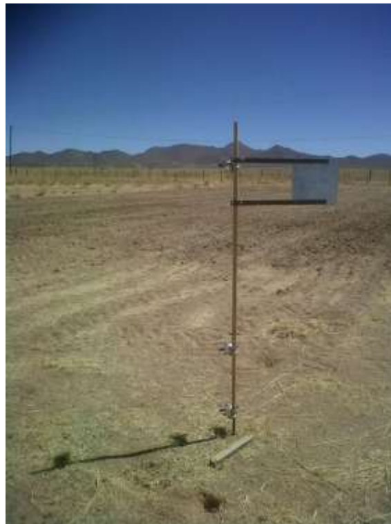
Figura 8.22. Foto de un mástil W&C en el lote. Fuente: EEA INTA Abra Pampa y FAUBA.
