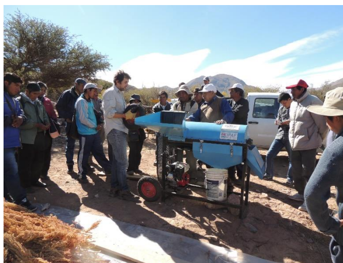
Primer ensayo a campo de máquina trilladora de quinua desarrollada por INTA-IPAF NOA.
