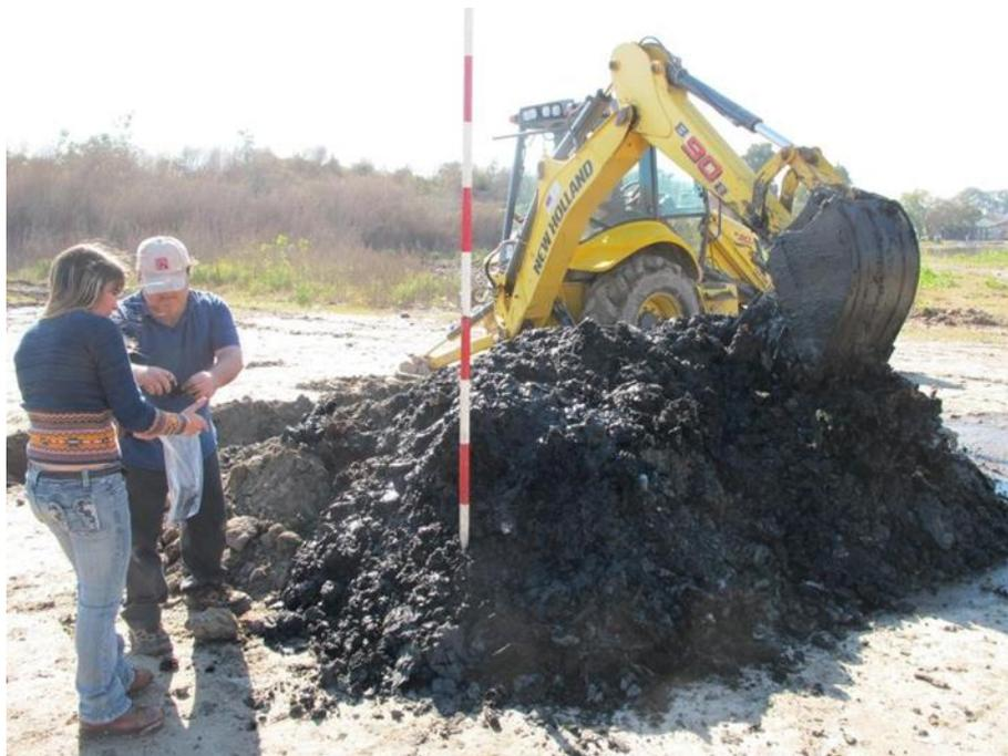
**Fig. 27. Sondeo 2. Sedimentos contaminados con hidrocarburos. Imagen tomada por M. Weissel.**
