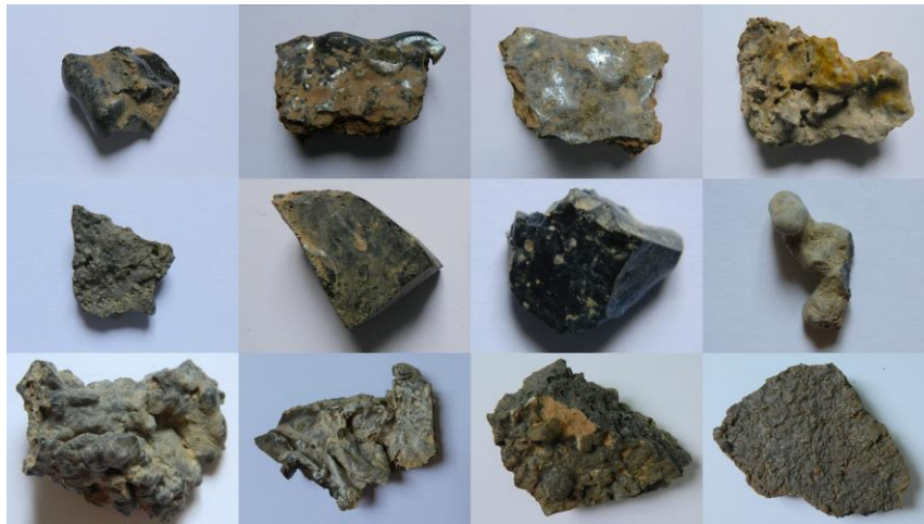
Figura 6.5: Selección de algunas de las escorias recuperadas en Fundiciones 2, tanto de fundición como de combustión.
