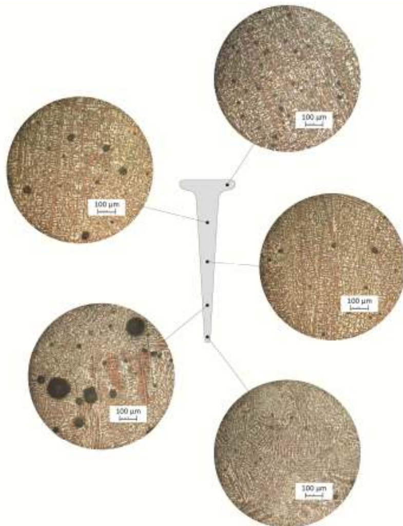
FIGURA A.10.26 – MICROESTRUCTURA DE UNA TACHUELA TIPO I.
