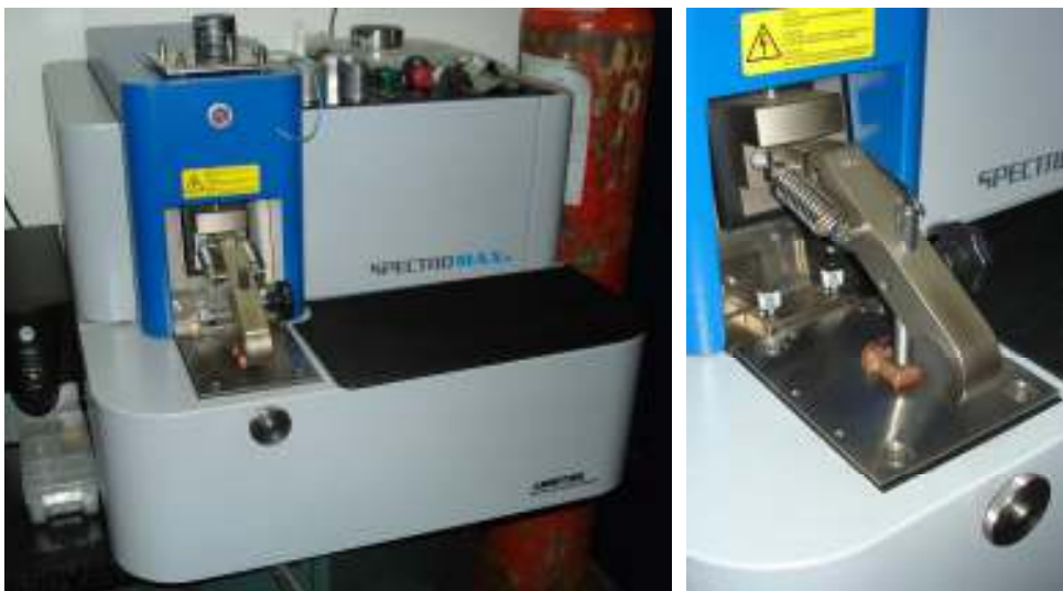
FIGURA 5.10 – ESPECTRÓMETRO, SPECTRO, MODELO MAXx LMF05.
