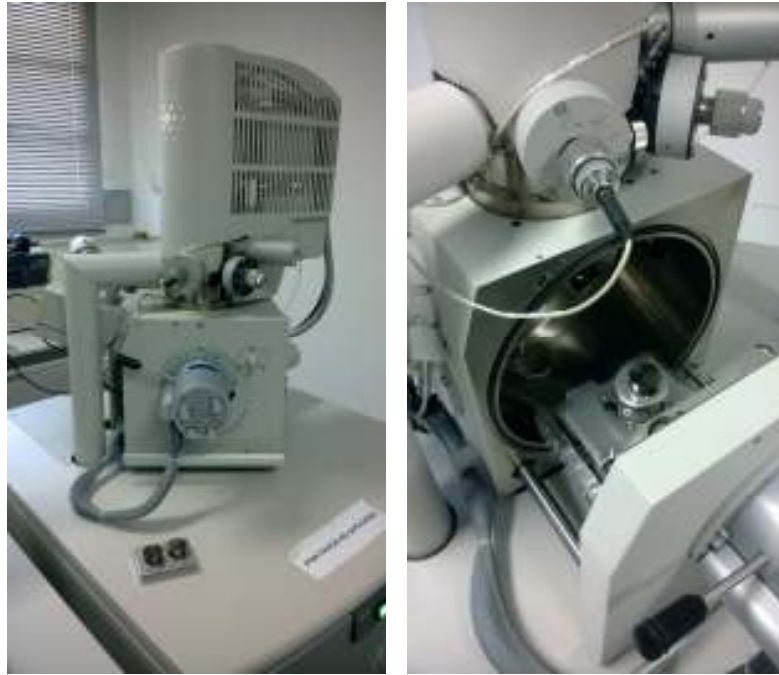
FIGURA 5.9 – MICROSCOPIO ELECTRÓNICO DE BARRIDO QUANTA FEG 250.
