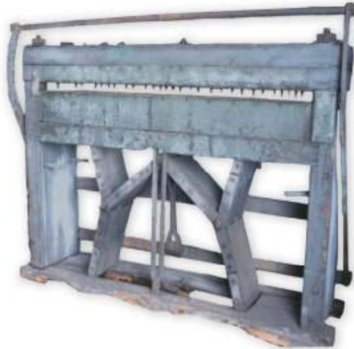
FIGURA 6.14 – MÁQUINA PARA PERFORAR CHAPAS DE LATÓN.
