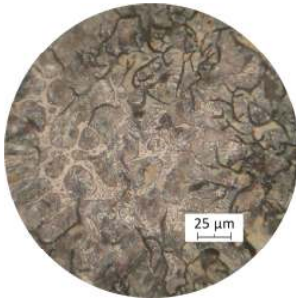
FIGURA A.10.51 – MICROESTRUCTURA DE FUNDICIÓN GRIS.
