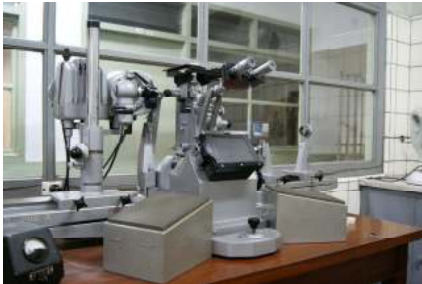
FIGURA 5.8 – MICROSCOPIO ÓPTICO METALGRÁFICO REICHERT ME F.
