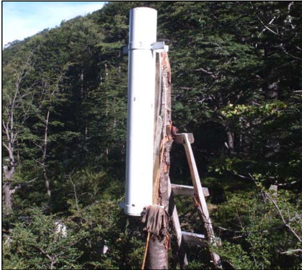
Foto 61. Pluviómetro instalado en las inmediaciones al refugio del cerro Hielo Azul
