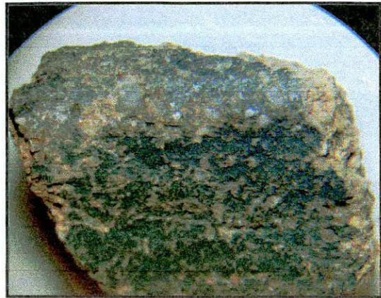
Imagen XVII: grado 1 de meteorización (lupa binocular). Imagen XVIII: grado 2 de meteorización (lupa binocular).
