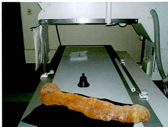
Figura 5.2 – Equipo de radioscopia SIEMENS y algunos de los artefactos seleccionados para análisis (Foto: N. Ciarlo 2008).
