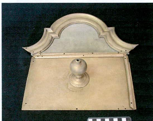
Figura 6.71 – Frente superior de la estufa ornamentado por una de las varillas del marco (Foto: D. Vainstüb 2002).
