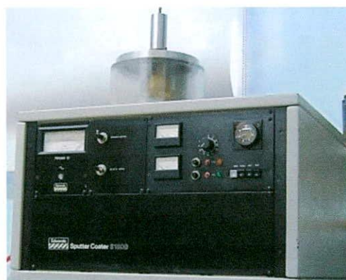
Figura 5.13 – Metalizadora EDWARDS S150B (Foto: cortesía de INTI-Mecánica 2009).
