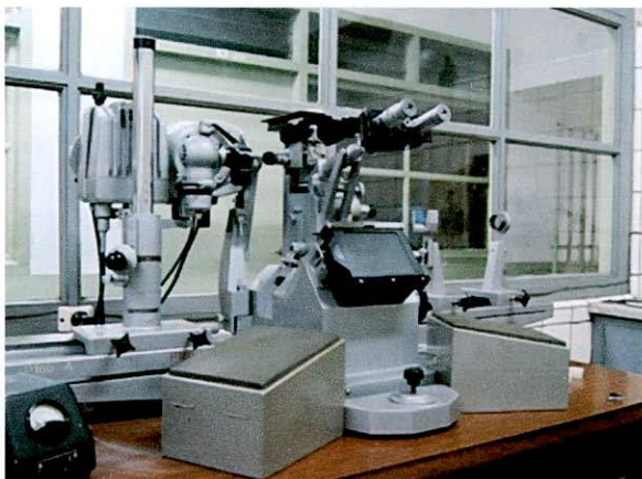
Figura 5.4 – Microscopio óptico metalográfico Reichert Me F (Foto: M. Lucchetta 2010).
