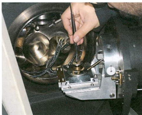
Figura 5.12 – Vista del interior de la recámara del SEM, donde se aprecia al operador mientras ingresa las muestras (Foto: N. Ciarlo 2007, cortesía de INTI-Mecánica).
