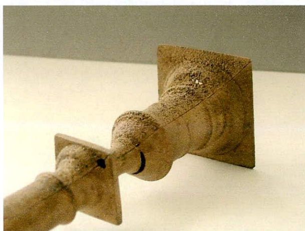
Figura 6.59 – Detalle de la superficie de las dos mitades de la pieza INA 251, una de las cuales presenta una porosidad acusada (Foto: N. Ciarlo 2008).
