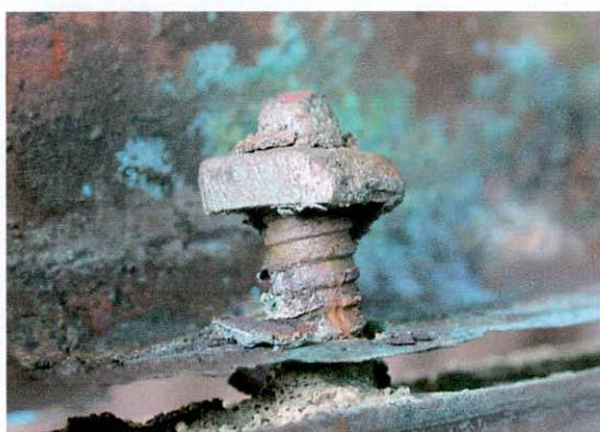
Figura 6.69 – Vista de uno de los tornillos de fijación del marco de la estufa (Foto: D. Vainstüb 2002).
