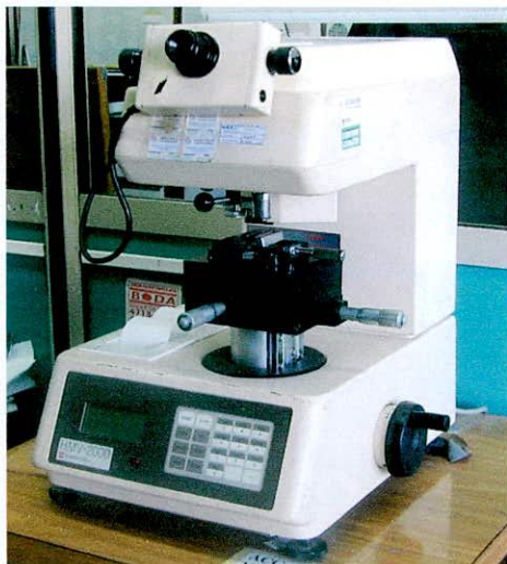
Figura 5.15 – Microdurómetro Shimadzu 2000 (Foto: cortesía de INTI-Mecánica 2010).
