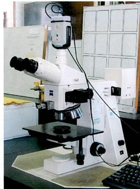
Figura 5.5 – Microscopio óptico metalográfico Zeiss Axiotech (Foto: cortesía de INTI-Mecánica 2010).
