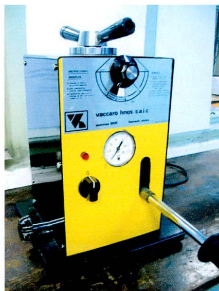
Figura 5.7 – Máquina incluidora Vaccaro Hnos., mod. VH141, utilizada en FI-UBA (Foto: M. Lucchetta 2010).
