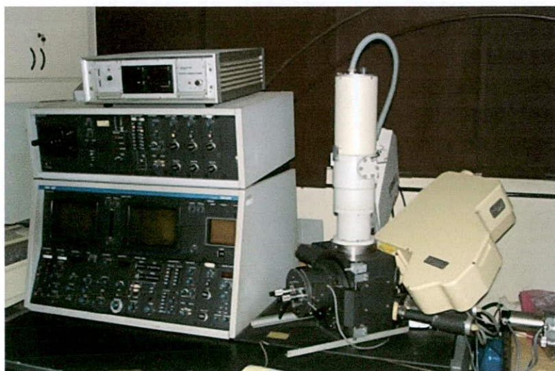
Figura 5.11 – Microscopio electrónico de barrido Philips 505 (Foto: N. Ciarlo 2007, cortesía de INTI-Mecánica).
