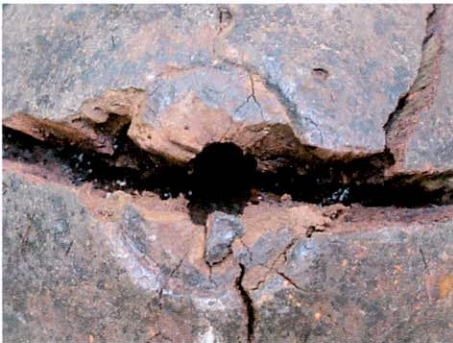
Figura 6.42 – Detalle de la marca del canal de colada (la grieta es producto de la corrosión de la pieza) del proyectil INA 47 (Foto: D. Vainstub 2002).
