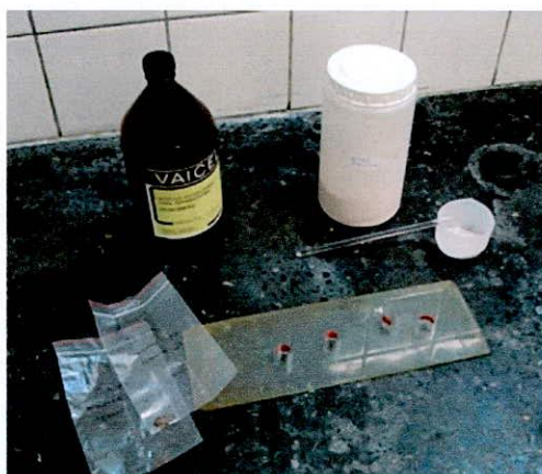
Figura 5.6 – Implementos utilizados durante el proceso de inclusión en frío (Foto: N. Ciarlo 2008).
